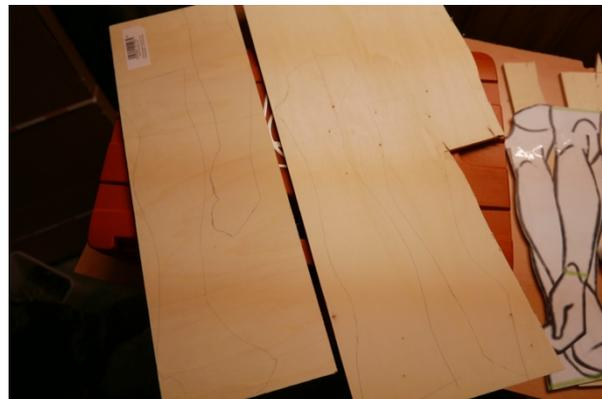
Abb. 20: Übertragung der Form auf die Holzplatten
