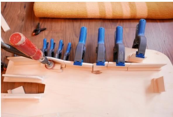
Abb. 45: Leimkonstruktion an der Seite
