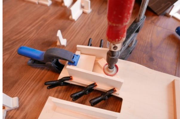
Abb. 42: Leimkonstruktion beim Becken
